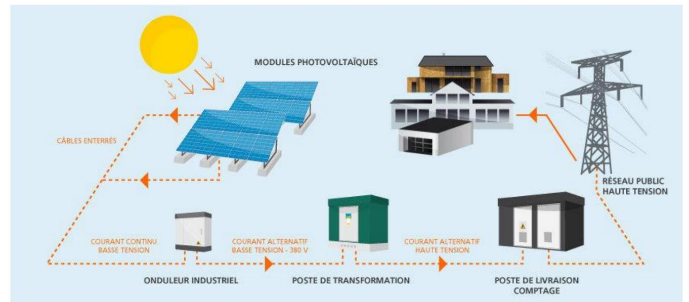
Figure 1 : Fonctionnement général d'une centrale photovoltaïque (Loir-et-Cher-Gouv, s.d.)
